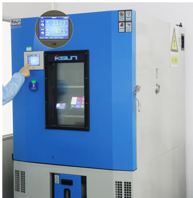
图 6-3 高低温老化测试图
