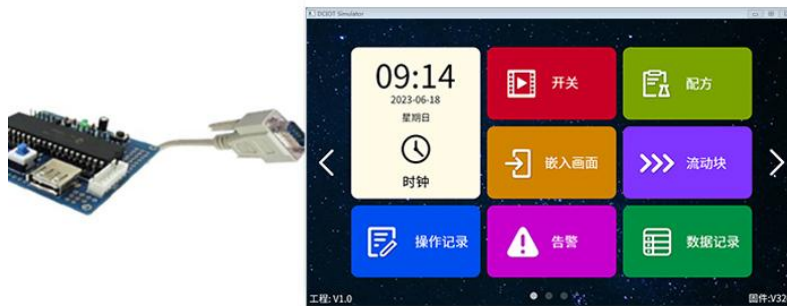
图 8-2 用户单片机串口与“HMI 模拟器”联机调试
